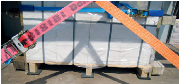
Bild 10: Einsatz von Anti-Rutschmatten unter einem Steinpaket
