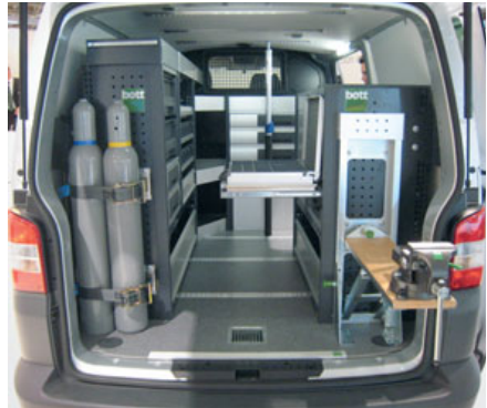
Bild 191 und 192: Sicherung von Schweißgasflaschen in einem Kastenwagen
