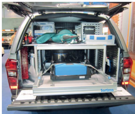
Bild 226: Ausrüstung eines Fahrzeuges mit einem Ladungssicherungssystem für die Unterhaltsreinigung
