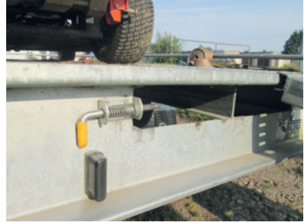
Bild 217 und Bild 218: In Ablagefächern unter der Ladefläche verstaute Auffahrrampen
