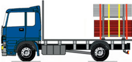
Bild 153: Sicherung der Gerüstbohlen und Gerüstholme in Barenen
