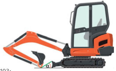
Bild 103: Vertikaler Zurrwinkel ( \alpha )
