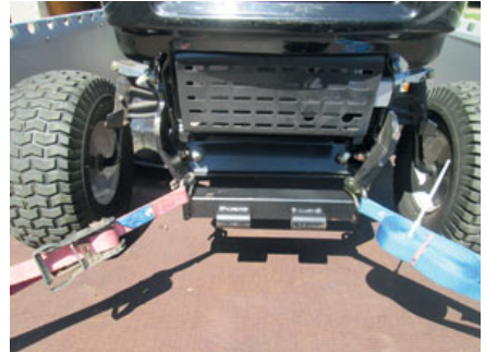
Bild 213 und 214: Nutzung der Räumschildtraverse als Zurrpunkt (Achtung: Zurrmittel müssen die gleiche Zugkraft (LC) und die gleiche Dehnung (%) aufweisen, Farbe ist nicht genormt)
