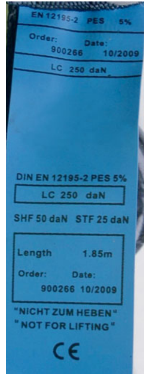
Bild 55: Zurrgurte dürfen keine CE-Kennzeichnung haben.
