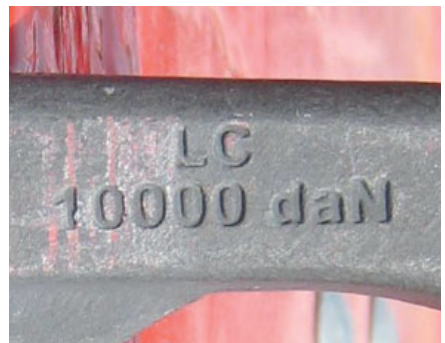
Bild 38 und 39: Neue Kennzeichnung von Zurrpunkten an Tiefladern
