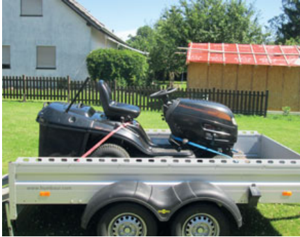
Bild 208: Sicherung des Aufsitzrasenmähers mit zwei Umreifungen (roter Zurrgurt in Fahrtrichtung, blauer Zurrgurt entgegen der Fahrtrichtung)
