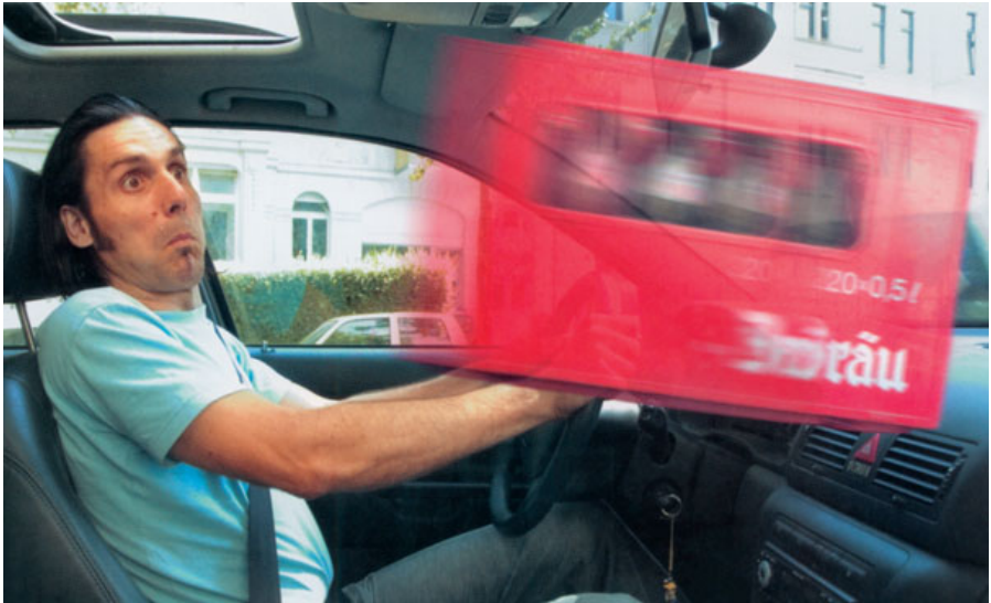
Bild 2: Bei einem Frontalaufprall mit 50 km/h entwickelt der ca. 18 kg schwere Getränkekasten die Wucht von 1 t.
