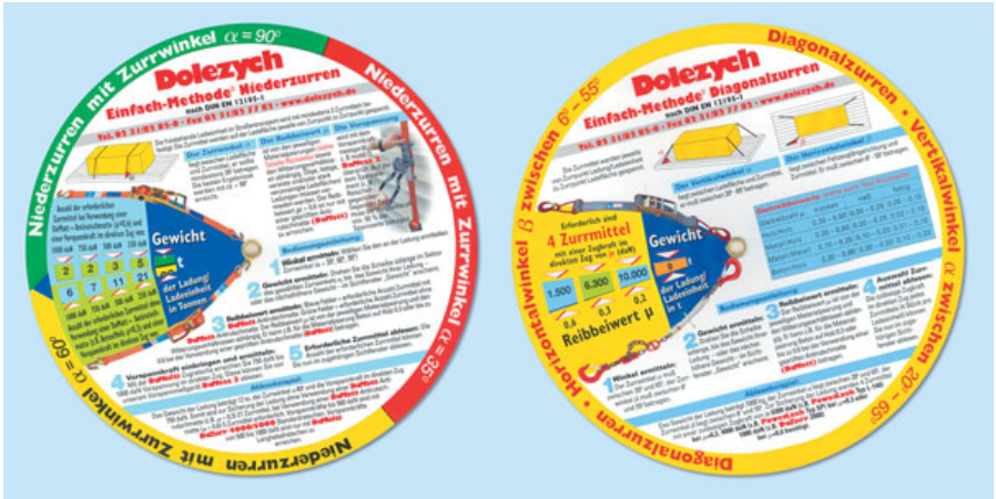
Bild 89: Schablone „Trucker-Disc“ zur Ermittlung der Anzahl der erforderlichen Zurrmittel
