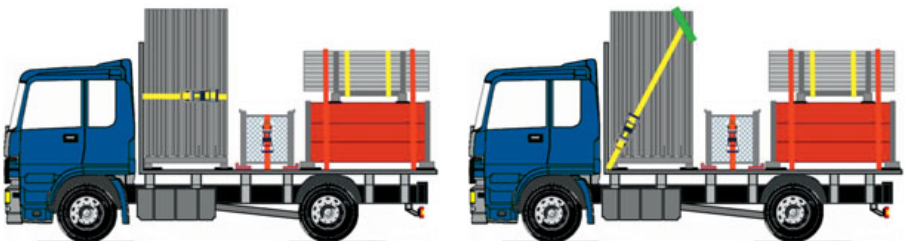
Bild 173 und 174: Sicherung der Gerüstbohlenstapel und Barenen mit zwei Niederzurrungen
