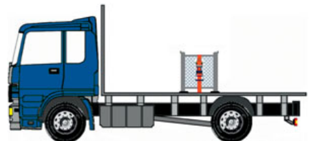
Bild 150: Sicherung der Modul-Gitterboxen
