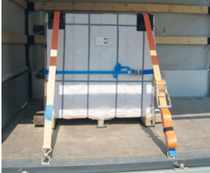
Bild 116: im Niederzurren mit zwei Zurrgurten und RHM gesichert
