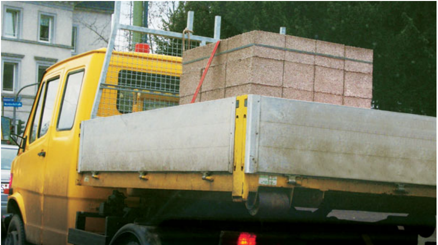
Bild 111: Versuchte Ladungssicherung eines Steinpaketes im Niederzurverfahren
