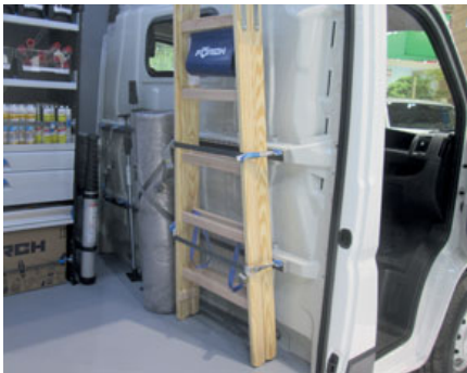
Bild 14: Festsetzen an der Trennwand im Kastenfahrzeug mit Umreifungszurren an einer Zurrutsche
