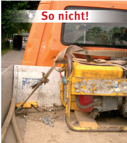
Bild 56: Nicht zulässiges Knoten von Zurrgurten
