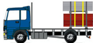
Bild 136: Barelle mit Gerüstbohlen, Holmen und Bordbrettern
