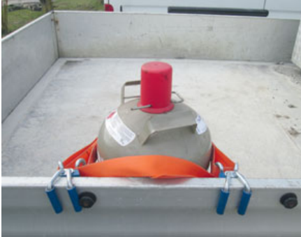
Bild 189 und 190: Sicherung einer Flüssiggasflasche mit einem Umreifungsgurt und Bordwandkrallen an der Bordwand eines Kleintransporters (Pritschenfahrzeug)
