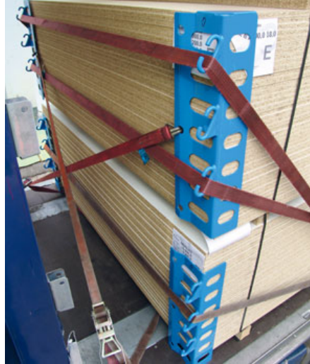
Bild 75 und 76: Zurrecken/Zurrwinkel als Hilfsmittel für eine sichere Umreifung bzw. Diagonalverzurrung
