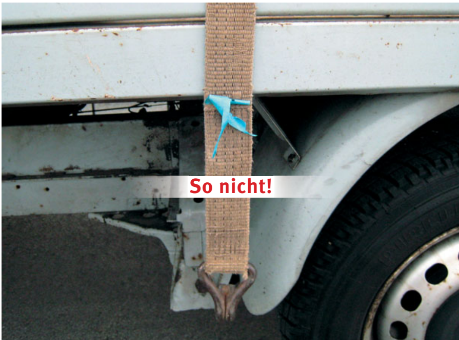
Bild 60: Zurrgurt ohne eindeutig lesbare Kennzeichnung
