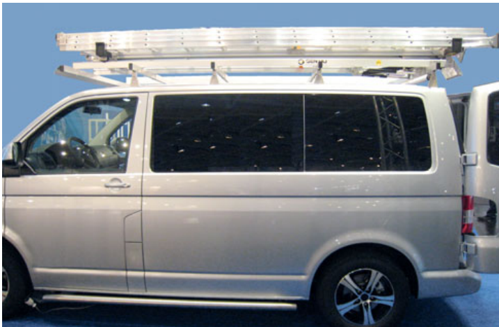
Bild 229: Leitertransport auf dem Dach
