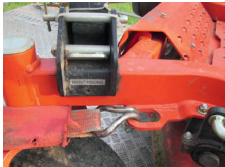
Bild 224 und 225: Nutzung der hier vorhandenen Zurrpunkte am Aufsitzrasenmäher
