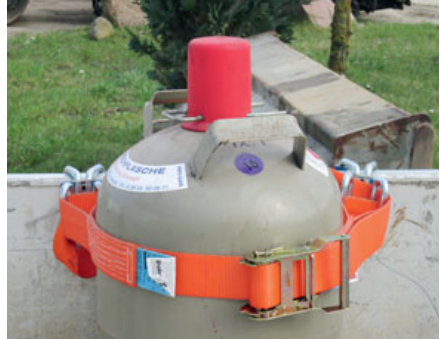
Bild 189 und 190: Sicherung einer Flüssiggasflasche mit einem Umreifungsgurt und Bordwandkrallen an der Bordwand eines Kleintransporters (Pritschenfahrzeug)
