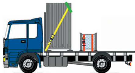
Bild 169 und 170: Sicherung der freistehenden Modul-Gitterboxen durch zwei Niederzurren
