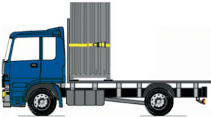
Bild 167: Gerüststrahmen stehend mit Umreifung
