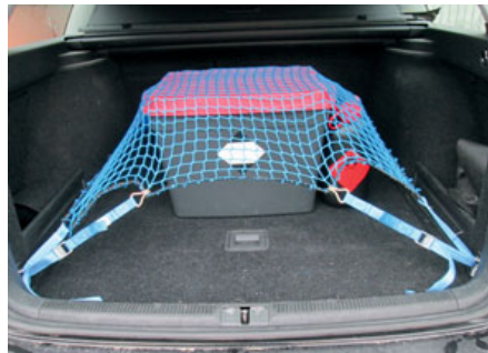
Bild 186: Außenverpackung mit einem Ladungssicherungsnetz gesichert
