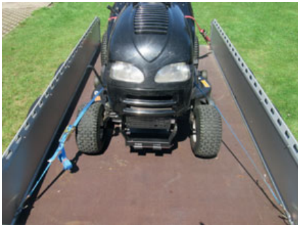
Bild 208: Sicherung des Aufsitzrasenmähers mit zwei Umreifungen (roter Zurrgurt in Fahrtrichtung, blauer Zurrgurt entgegen der Fahrtrichtung)
