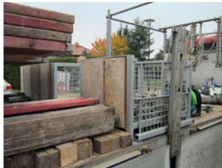
Bild 162: Barenen als Formschluss für liegendes Gerüstmaterial
