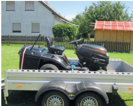
Bild 205: Sicherung des Fangkorbes am Aufsitzrasenmäher durch eine Niederzurrung
