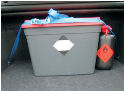
Bild 185: Außenverpackung mit einem Umreifungsgurt (einteiliger Zurring) gesichert
