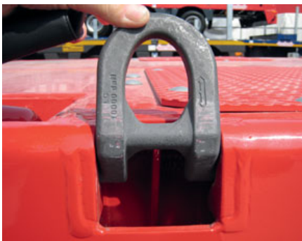
Bild 38 und 39: Neue Kennzeichnung von Zurrpunkten an Tiefladern
