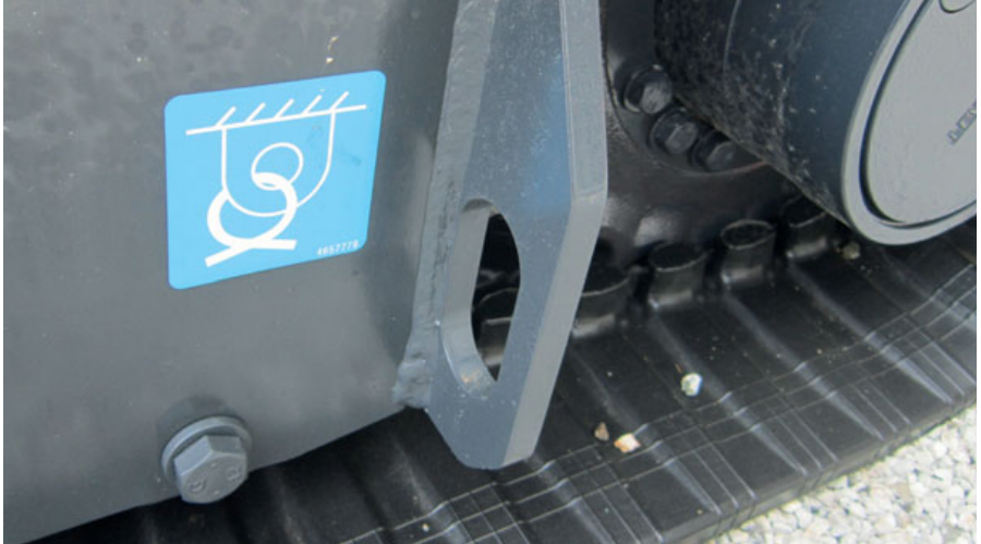
Bild 42: Kennzeichnung eines Zurrpunktes an einem Raupenbagger
