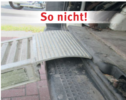
Bild 196: nicht bestimmungsgemäße Verwendung einer Anhängerauffahrrampe am Kastenfahrzeug, nicht arretiert
