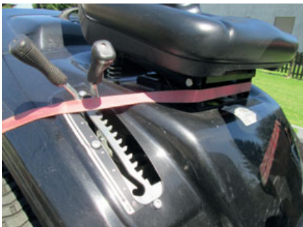
Bild 209 bis 212: Detail der Umreifung (Achtung: bei scharfen Kanten Kantenschoner verwenden)
