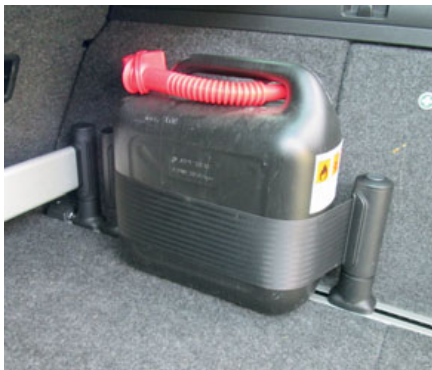
Bild 187: Sicherung eines Kraftstoffkanisters im Kofferraum mit einem Umreifungsgurt
