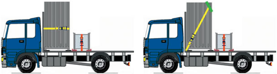
Bild 171 und 172: Sicherung der blockierten Modul-Gitterbox mit einer Niederzurrung
