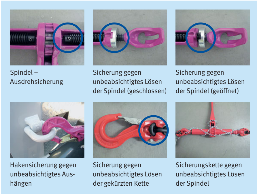
Bild 62: Sicherungselemente an einer Zurrkette nach DIN EN 12195-3
