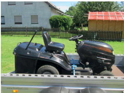
Bild 201 und 202: Niederzurren des Aufsitzrasenmähers im Bereich der Fußbretter
