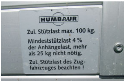
Bild 200: Zulässige Stützlast der Deichsel des Anhängers
