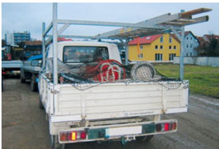
Bild 230: Leitertransport auf dem Spriegelgestell
