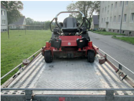
Bild 222 und 223: Diagonallatten mit Zurrgurten, Zulässige Zugkraft der Zurrpunkte am Tandemanhänger lt. Hersteller 850 daN
