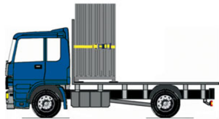
Bild 147: Sicherung der Stellrahmen auf Stellrahmenpaletten mit waagerechter Umreifung bei vorhandenen Zurrpunkten an der Stirnwand
