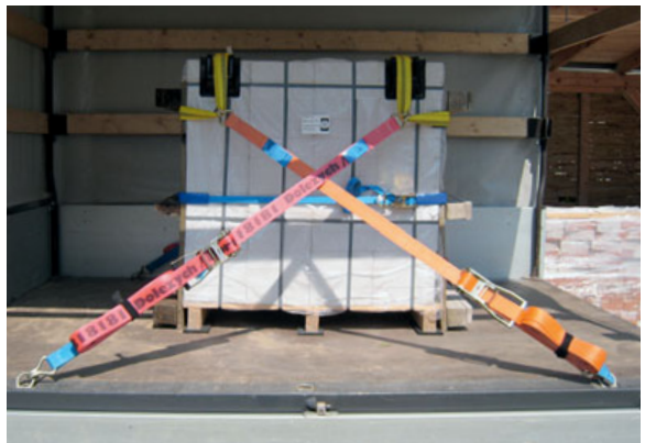
Bild 73: Sicherung eines Steinpaketes auf der Ladefläche durch Rundschnlingen als Kopflaschen sowie RHM-Materialien unter der Einwegpalette
