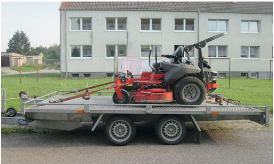
Bild 219: Aufsitzrasenmäher mit einem Gewicht von ca. 625 kg auf einem Tandemanhänger im Diagonalzurrverfahren gesichert
