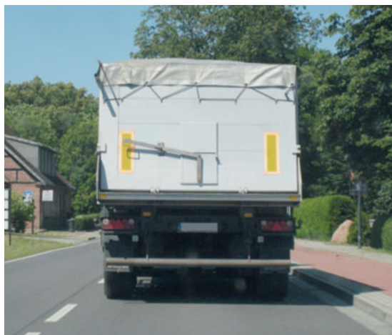
Bild 41: Ladegut mit Plane gesichert
