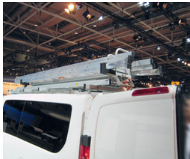
Bild 234 und 235: Leitersicherung auf dem Dach eines Transportfahrzeuges. Einstellen der Leiter in den Tragschlitten, Befestigung mit Zurrgurten, Schieben des Tragschlittens auf das Dach, Einrasten in den Grundträger, Lösen der Sicherung von unten
