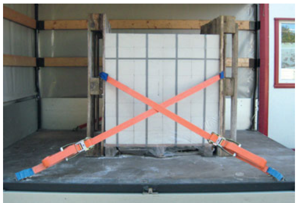
Bild 74: Mittels Paletten formschlüssige Sicherung durchgeführt
