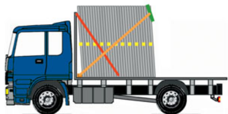
Bilder 142 und 143: Sicherungsvariante für Gerüststellrahmen ohne Stellrahmenpalette und ohne Zurrpunkte in der Stirnwand mit Rücksicherung der Stirnwand (roter Zurrgurt)
