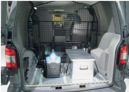
Bild 24: Trenngitter zwischen Fahrgastzelle und Laderaum
