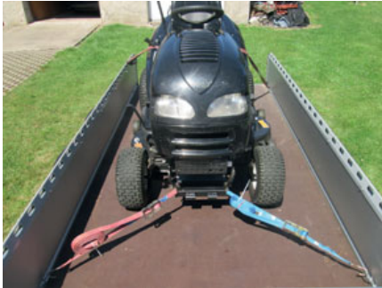
Bild 213 und 214: Nutzung der Räumschildtraverse als Zurrpunkt (Achtung: Zurrmittel müssen die gleiche Zugkraft (LC) und die gleiche Dehnung (%) aufweisen, Farbe ist nicht genormt)
