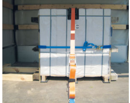
Bild 117: Im Niederzurren mit einem Zurrgurt, RHM und Blockieren gegen die Stirnwand gesichert
