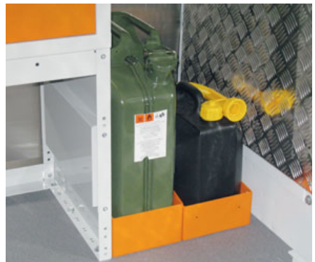
Bild 188: Sicherung von Kraftstoffkanistern in Blockiereinrichtungen/Halterungen
