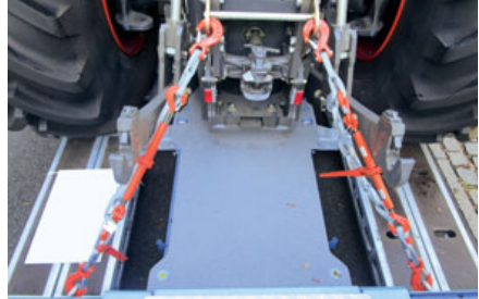
Bild 19: Diagonalzurren mit Textil-Zurrketten aus Dyneema
