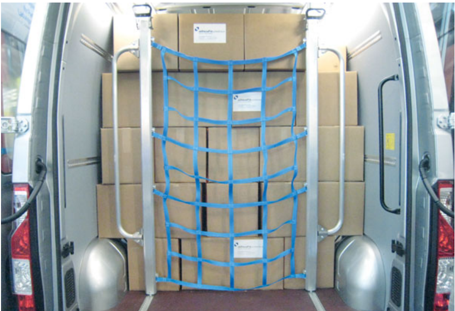
Bild 70: Verwendung eines vertikalen Ladungssicherungsnetzes
