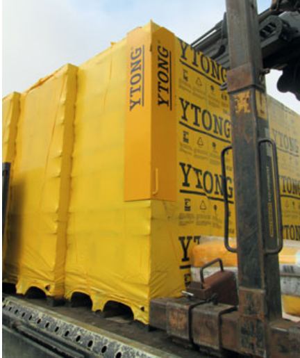
Bild 75 und 76: Zurrecken/Zurrwinkel als Hilfsmittel für eine sichere Umreifung bzw. Diagonalverzurrung
