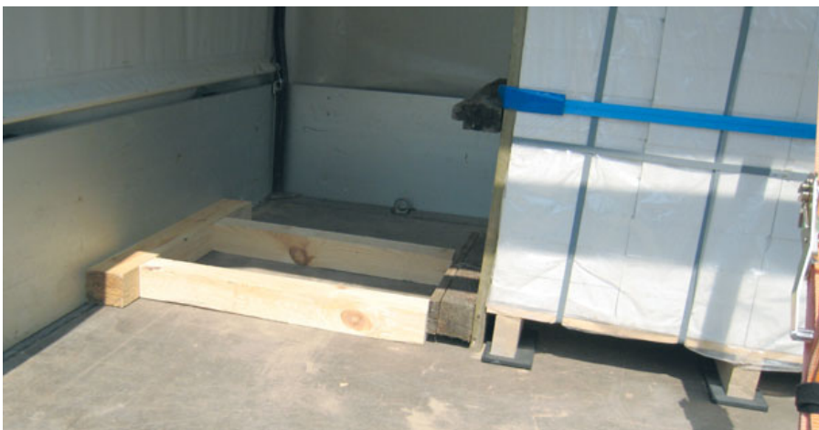
Bild 77: Mittels Holzkonstruktion formschlüssige Sicherung durchgeführt
