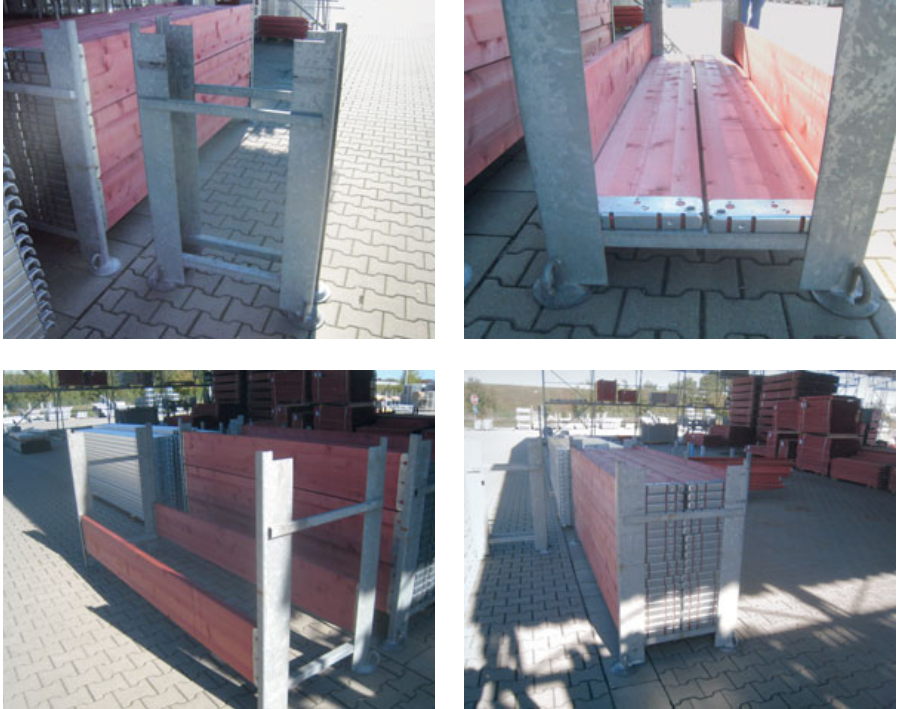
Bild 163 bis 166: Sicherer Transport von 44 Gerüstbohlen in einer Stapelbox
