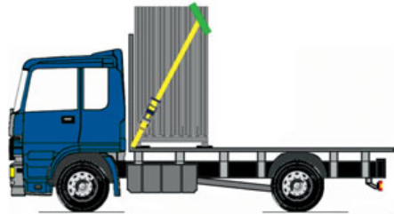
Bild 168: Gerüststrahmen stehend mit Kopflashing und Diagonalzurren
