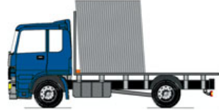
Bild 133 und Bild 134: Stehende Stellrahmen in Stellrahmenpalette oder angelehnt an die Stirnwand
