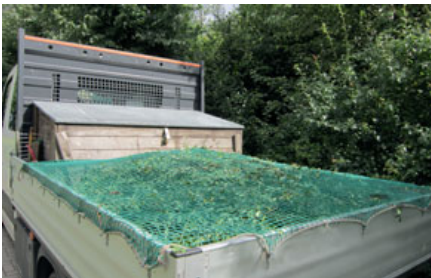
Bild 20: Abdeckung mit Netz, formschlüssige Sicherung für leichte Ladung, welche herunterwehen könnte
