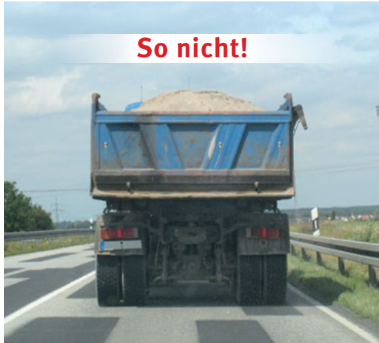
Bild 40: Schüttgut nicht gesichert
