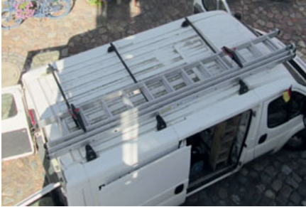
Bild 231: Leitertransport auf dem Dach mit Sicherung, siehe Details
