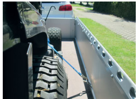
Bild 201 und 202: Niederzurren des Aufsitzrasenmähers im Bereich der Fußbretter
