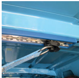
Bild 236 und 237: Sicherung einer Leiter mittels Zurrschienen und Zurrgurten am Fahrzeugdach
