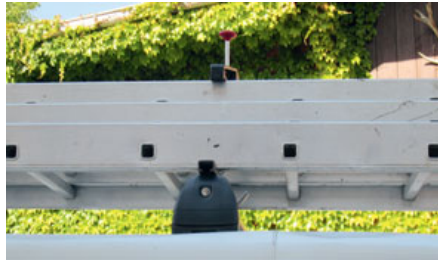
Bild 232 und 233: Details der Leitersicherung
