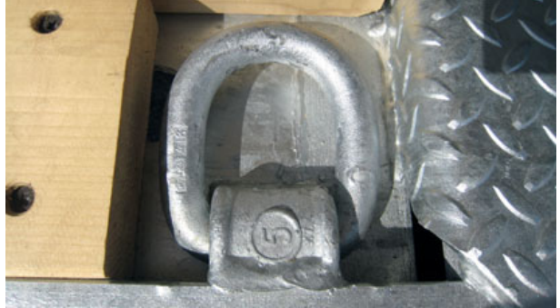
Bild 36: Bisherige Kennzeichnung von Zurrpunkten an einem Tieflader
