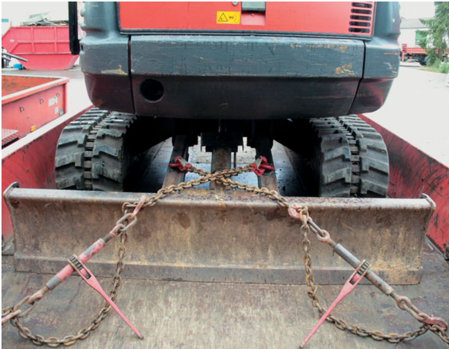
Bild 44: Zurrpunkte am Bagger durch das Bau-Unternehmen in Abstimmung mit dem Hersteller nachgerüstet.
