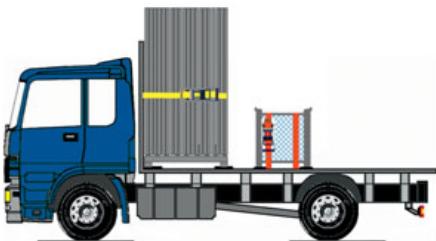
Bild 169 und 170: Sicherung der freistehenden Modul-Gitterboxen durch zwei Niederzurren
