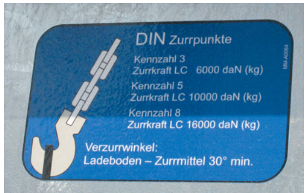
Bild 37: Kennzeichnung und Belastbarkeit der Zurrpunkte an einem Tieflader
