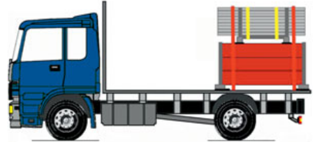
Bild 154: Sicherung der Gerüstbohlen in Gerüstbohlenboxen und Gerüstholme in Barenen
