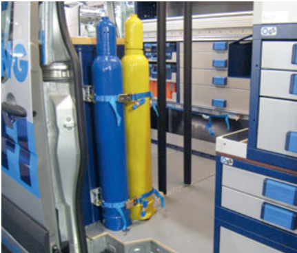
Bild 191 und 192: Sicherung von Schweißgasflaschen in einem Kastenwagen
