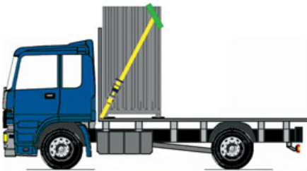
Bild 146: Sicherung der Stellrahmen auf Stellrahmenpaletten im Diagonalzurverfahren
