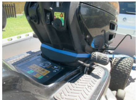
Bild 209 bis 212: Detail der Umreifung (Achtung: bei scharfen Kanten Kantenschoner verwenden)
