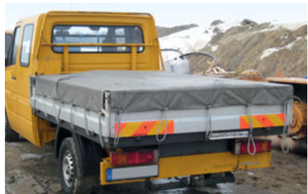
Bild 21: Abdeckung mit Plane, formschlüssige Sicherung für leichte Ladung, welche herunterwehen könnte
