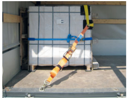
Bild 15: Festsetzen an der Stirnwand kombiniert mit Kopfschlingenzurren
