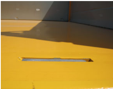
Bild 32 und 33: Dreiseitenkipper, vom Hersteller mit Zurrpunkten ausgerüstet
