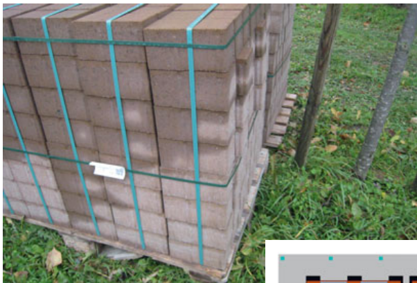
Bild 48: Eine Verpackung mittels Umreifungsbändern ersetzt nicht die Bildung einer Ladeeinheit.
