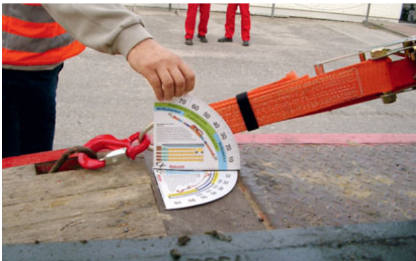
Bild 89: Schablone „Trucker-Disc“ zur Ermittlung der Anzahl der erforderlichen Zurrmittel
