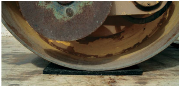
Bild 9: Einsatz einer Anti-Rutschmatte unter der Bandage einer Walze
