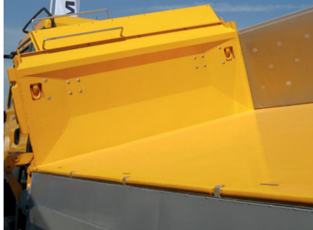
Bild 31: Einzel-Zurrpunkte in der Stirnwand bzw. Lade­fläche eines Drei-Seiten-Kippers
