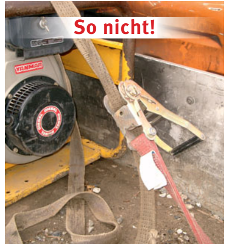
Bild 57: Nicht arretierte Zurrgurt-Ratsche und verdrehter Gurt
