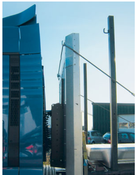
Bild 27 und 28: „Stabilisierung“ der Stirnwand. Hierzu kann um die Stirnwand ein Zurrmittel gelegt werden. Dieses wird erst nach der Beladung handfest vorgespannt und vor der Entladung entspannt.
