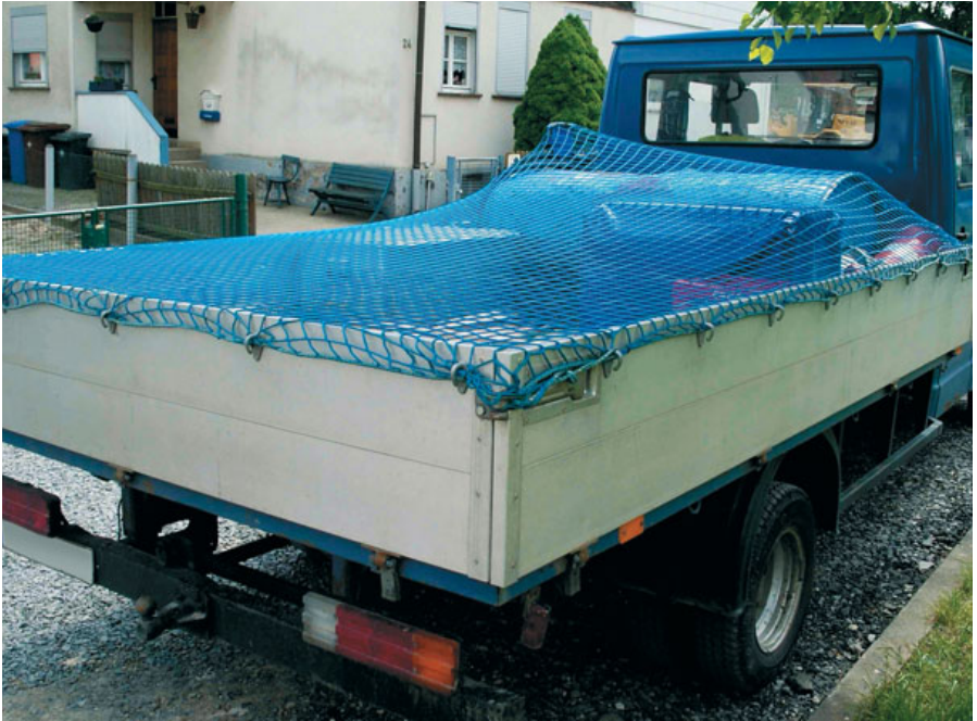
Bild 68: Verwendung von Abdecknetzen, um leichte Ladung am Wegfliegen zu hindern.
