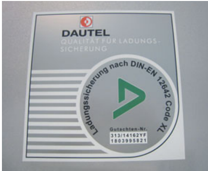
Bild 26: Kennzeichnung eines 3-Seiten-Kipper-Aufbaus, der Aufbau erfolgte nach DIN EN 12642:2007-01.
