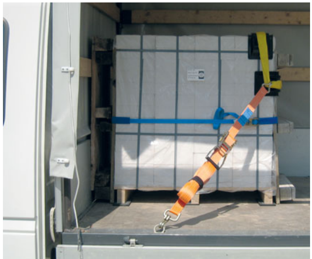
Bild 130: Steinpaket mit einem Zurrgurt und rutschhemmendem Material gesichert, gegen Verdrehen durch Blockierung an der Stirnwand gesichert
