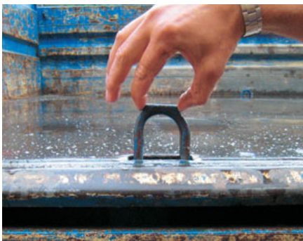
Bild 34 und 35: Dreiseitenkipper, Zurrpunkte nach Angaben der Anwender vom Hersteller/Aufbauer nachgerüstet
